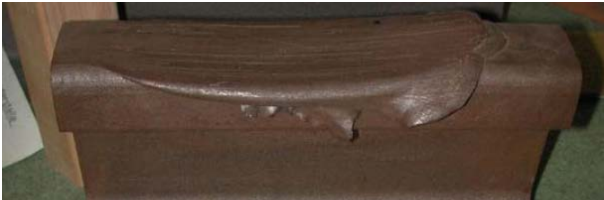
Abbildung 26: Schienendeformation nach Schleudervorgang eine E-Lok [31]
