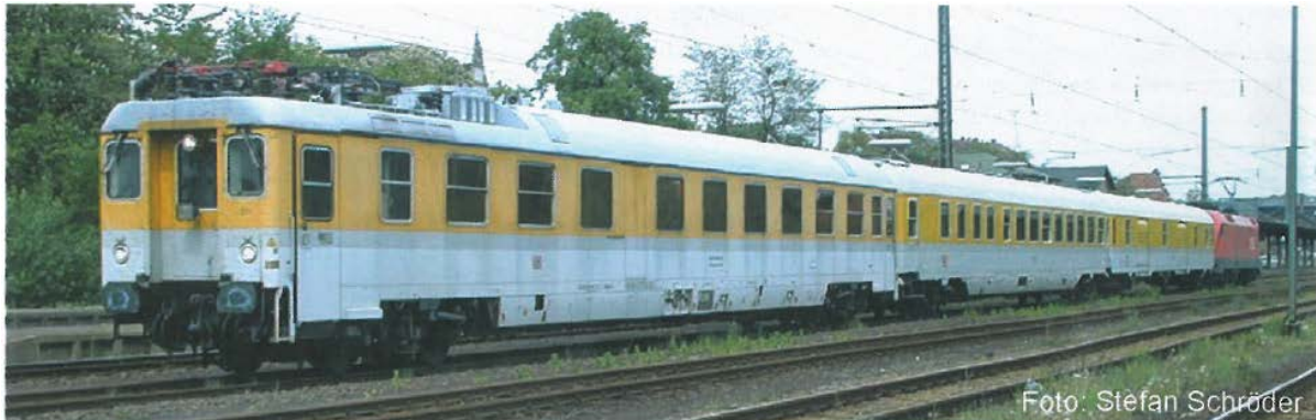
Abbildung 63: Schallmesszug der DB Systemtechnik [44], drei Messwagen und hier nur eine, meist jedoch am jedem Ende eine Lok
