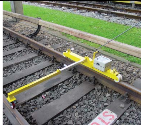
Abbildung 70: Messung der Schienenrauheit mit Rail Surface Analyser [63]
