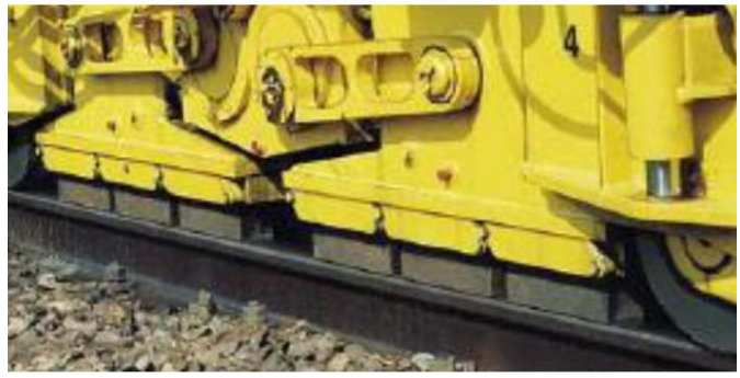
Abbildung 35: Schienenoberfläche nach oszillierender Schienenbearbeitung [45] und Schienenschleifmaschine mit oszillierendem Schleifverfahren [46]
