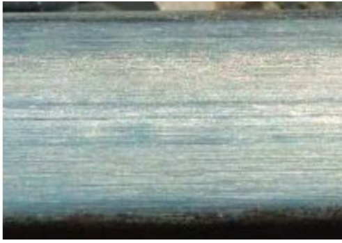
Abbildung 35: Schienenoberfläche nach oszillierender Schienenbearbeitung [45] und Schienenschleifmaschine mit oszillierendem Schleifverfahren [46]
