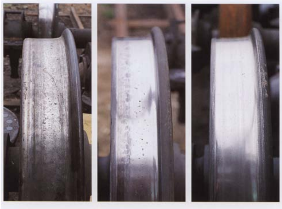
Abbildung 46: Änderung der Oberflächenbeschaffenheit (links: Grauguss, mittig: LL-Sohle, rechts: Scheibenbremse).
