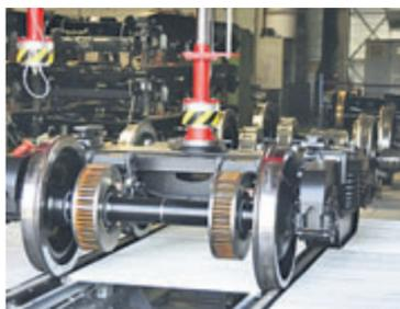
Leise Drehgestelle sollen die Fahreigenschaften der Räder an Zügen verbessern und sie dadurch leiser machen. Die Radsätze schonen Gleise und Räder. Dadurch gibt es weniger Abrieb. Weil das Rad beweglich ist, springt es in Kurven nicht so leicht, was den Lärm beim Fahren reduziert.
