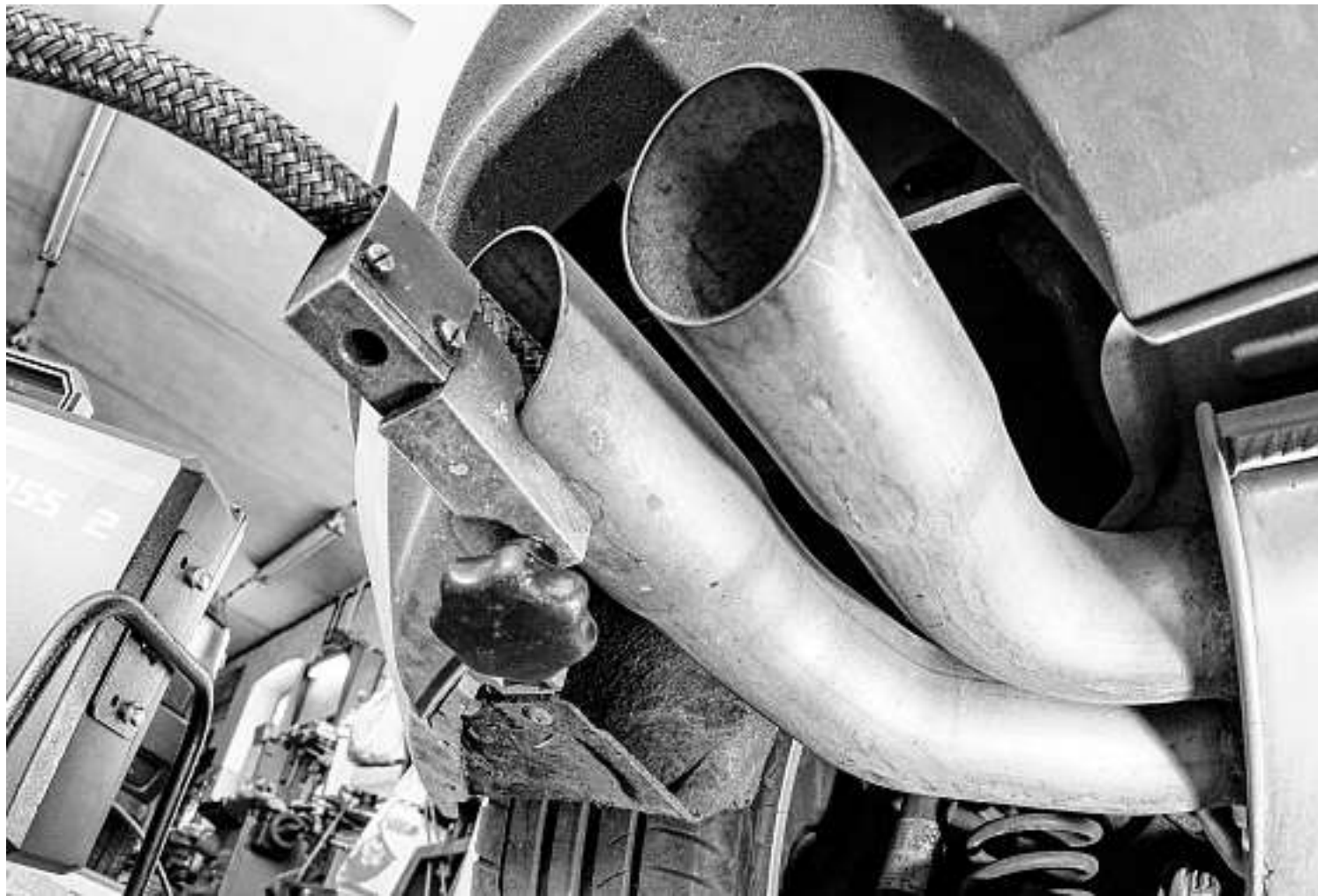
Abgasuntersuchung eines Dieselmotors – dafür wird ein Messschlauch ins Auspuffrohr des Fahrzeugs gesteckt.
