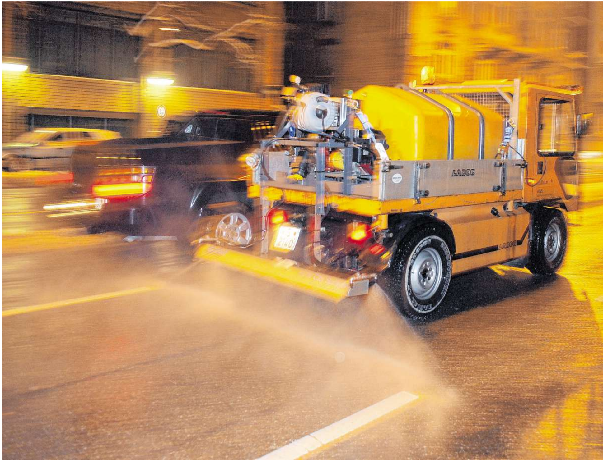
Im Einsatz gegen den Feinstaub: In der baden-württembergischen Landeshauptstadt Stuttgart wird in den frühen Morgenstunden rund um das Neckartor ein Sprühmittel ausgebracht. Ob die Maßnahmen helfen, die Luftqualität zu verbessern, wird laufend überprüft. FOTO: BERND WEISSBROD
