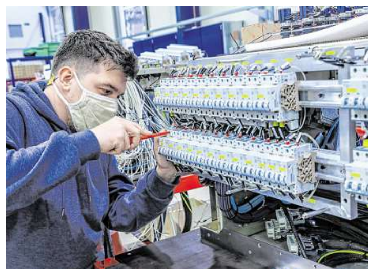
Ein Mitarbeiter verschraubt die elektrische Ausrüstung eines Führerpultes des Velaro Rus – für die Russische Eisenbahn.
