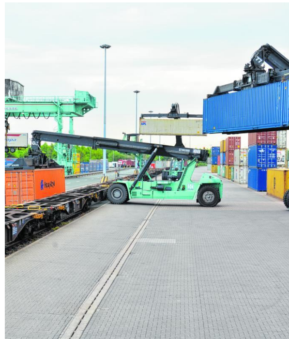
Kranfahrer heben auf der Anlage von Roland Umschlag im Bremer Güterverkehrszentrum Container auf einen Zug.
