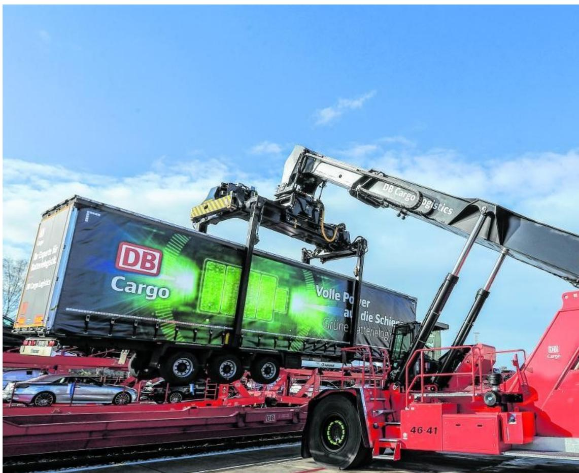
Im Automobil-Logistikcenter von DB Cargo in Sebaldsbrück: Ein Greifstapler lädt einen Lkw-Trailer vom Güterzug. Darin sind bis zu 21 Batterien für den neuen Mercedes EQE, der seit einigen Wochen auch in Bremen gefertigt wird.
