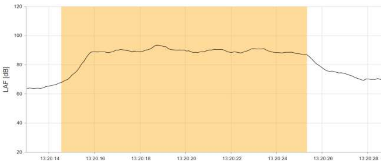
Abbildung 2.1: Pegelverlauf der Güterzugvorbeifahrt mit v = 91 \text{ km/h} an der Messstelle Andernach am 10.12.2024, 13:20:15 Uhr (Quelle https://www.laerm-monitoring.de/zug?mp=8 )
