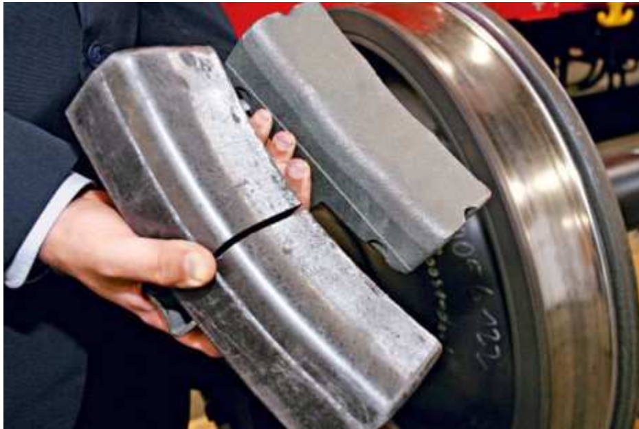
© Fotos: dpa/Picture alliance Im Vergleich: Bremsbelag aus Grauguss [r.] und Flüsterbremse.
