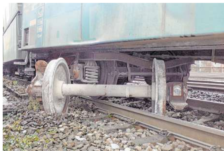
Experten schätzen, dass ein Schaden an einer Achse die Ursache für den Unfall war.
