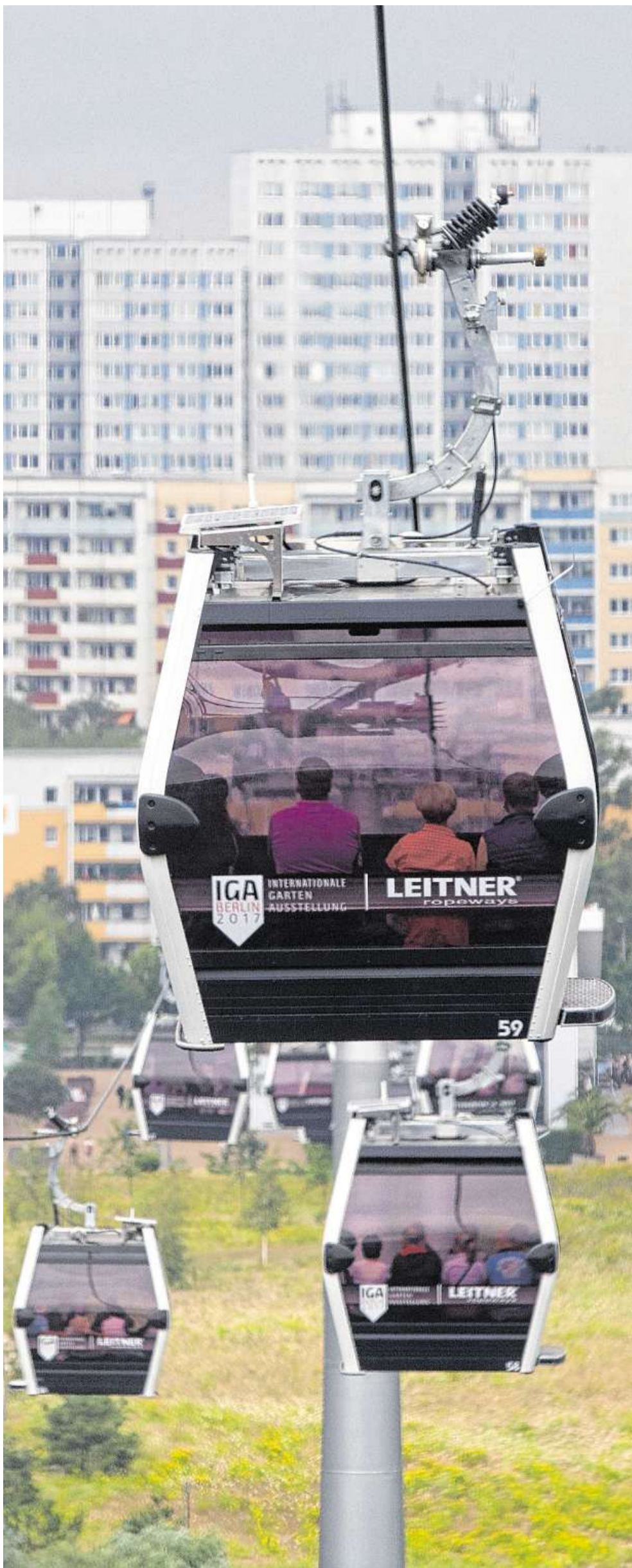
Die Berliner Seilbahn wurde für die Internationale Gartenausstellung 2017 gebaut. Technisch gesehen ist sie eine „Einseil-Umlaufbahn“. FOTO: JÖRG CARSTENSEN/DPA
