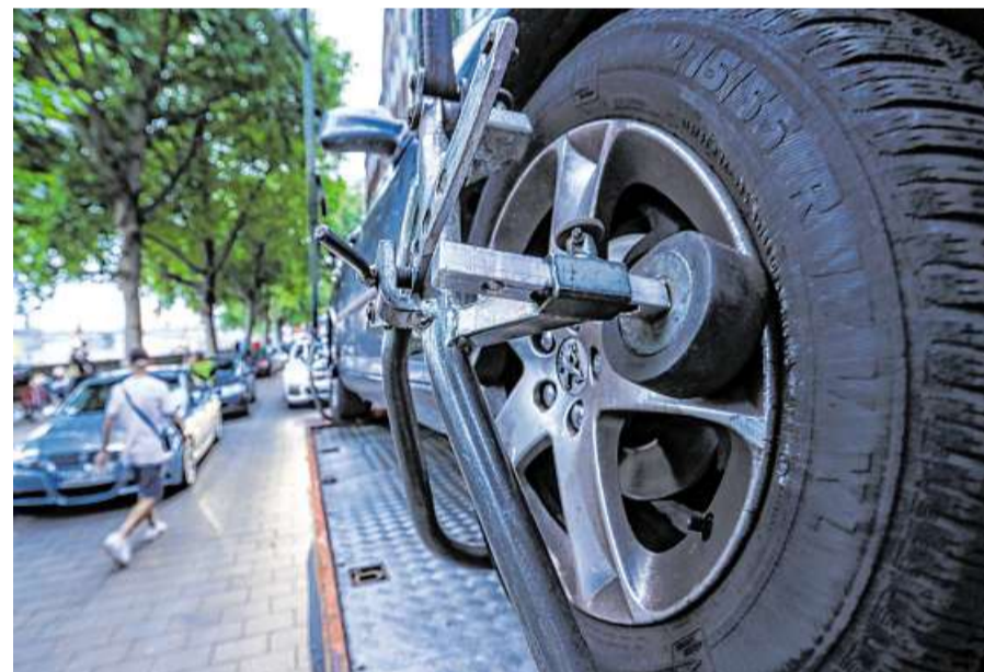
Die Radkralle wird an der Felge befestigt, danach wird die Kralle mit dem Kran verbunden – und das Auto hängt am sogenannten Galgen des Abschleppwagens.
