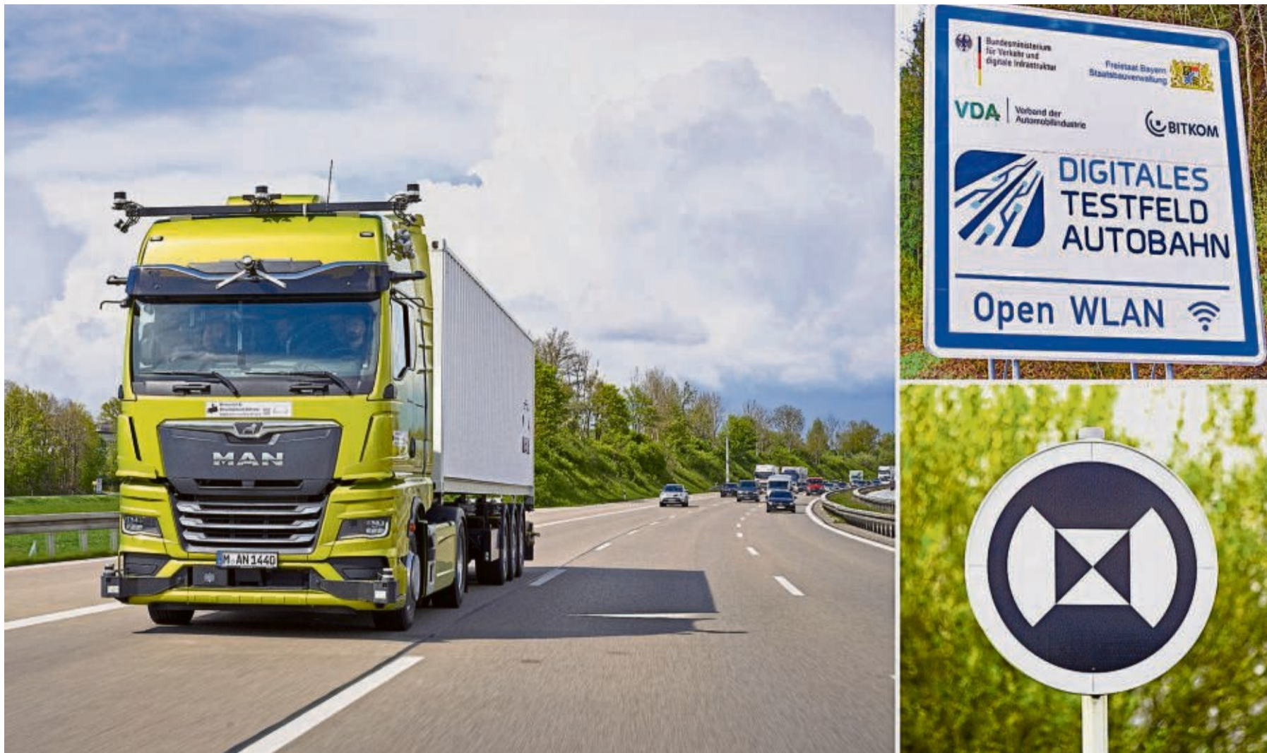
Der Lkw-Hersteller MAN testet autonom fahrende Lastwagen auf der A9. Die schwarz-weißen Landmarkenschilder (Bild unten rechts) ermöglichen den Fahrzeugen den exakten Standort zu bestimmen.
